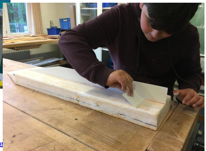
Mertkan (Klasse 8c) spachtelt den Rumpf, der dann am nächsten Tag von Arsim (Klasse 8f) und Mertkan geschliffen wird (Bild nächste Seite). Der Kiel ist auch schon angebaut ist.
