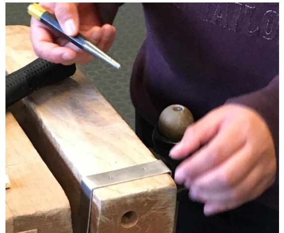
Herstellung der Motorhalterung: Mertkan köhrt die bereits abgekanetete Aluleiste für die nötigen Bohrungen.
